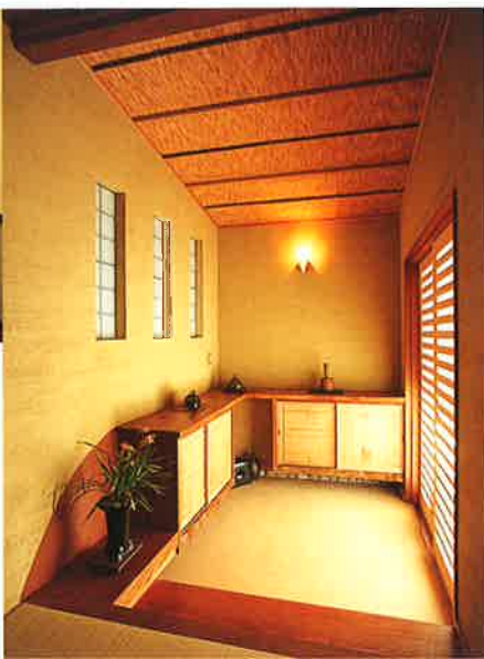
写真右／左官仕上げの土壁と土間が印象的な玄関。上がり框は、もとの家にあったものをカンナ掛けて再利用した。 写真左／古い和箆が収まる座卓の間。座卓は掘りごたつ式となっており、大人数の来客にも対応できる。壁面の三つの窓は、採光用兼デザインのポイントにもなっている。
