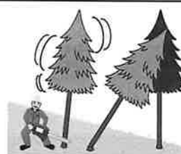
(図4) かかり木に激突させるためにかかり木以外の立木の伐倒
