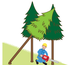
(図3)かかっている立木の伐倒
